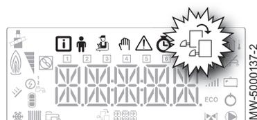
L'afficheur indique l'état de fonctionnement de la chaudière, la température départ chauffage et les codes erreurs éventuels.
